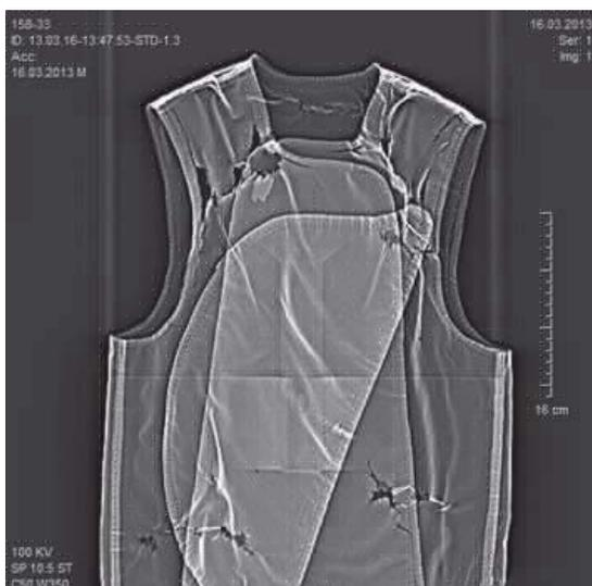
Abbildung 7. Beschädigte Röntgenschürze [9]
